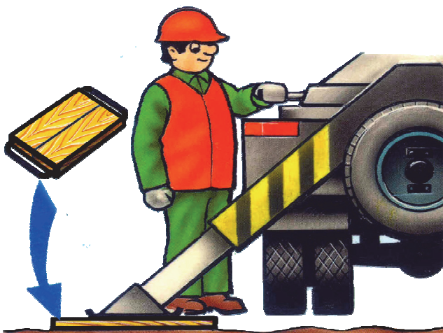
Рис. 12. Установка подъемника на опоры
